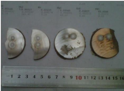
Gambar 17 Spesimen Uji Komposisi
