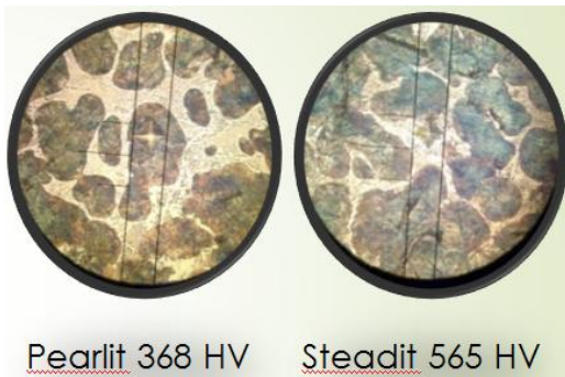
Gambar 25 Jejak Penekanan (Pearlite-kiri, Steadit-kanan)
