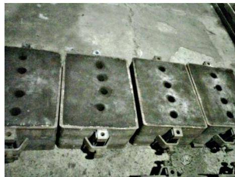
Gambar 15 Cetakan Spesimen Uji
