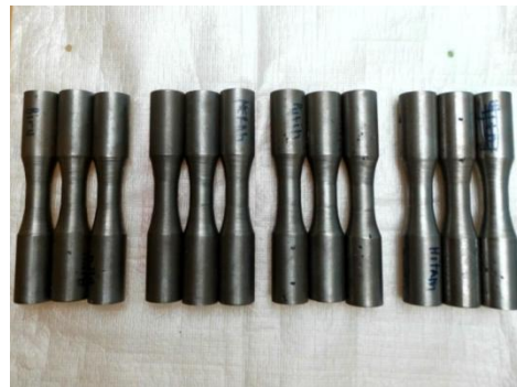
Gambar 22 Spesimen Uji Tarik
