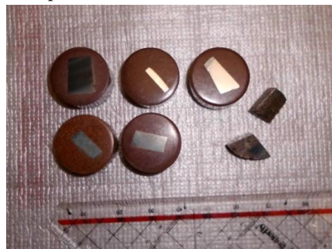
Gambar 18 Spesimen Uji Struktur Mikro
