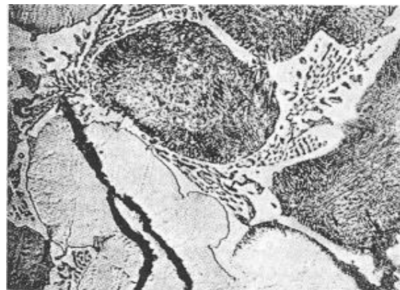
Gambar 2 Struktur Besi Cor Dengan Phospideutektik
