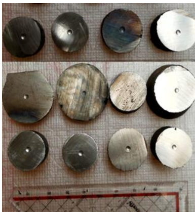
Gambar 20 Spesimen Uji Kekerasan Brinell
