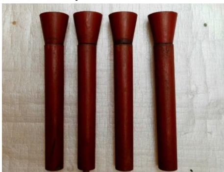
Gambar 14 Pola Spesimen Uji Tarik
